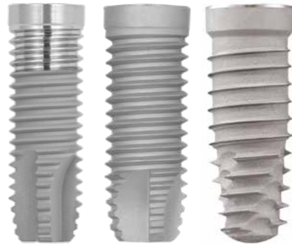
Verschiedene Entwicklungsstufen eines parallelwandigen Implantates (v.l.n.r.: alle BIOMET 3i): Osseotite® Hybridimplantat (maschinierter Kragen; Sa: 0,2 – 0,5 µm), FullOsseotite® (Sa: 0,5 µm), T3® non-platform-switched (unterschiedlicher Rauigkeiten vom Kragen zum Implantatkörper; Sa: 0,5 – 1,4 µm)
